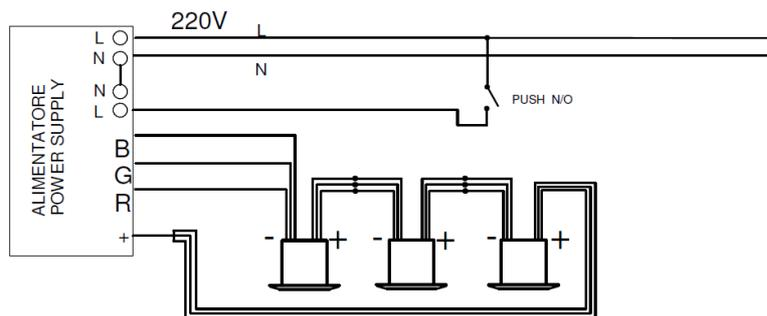
Con il cavo in dotazione è possibile sincronizzare max 20 apparecchi
