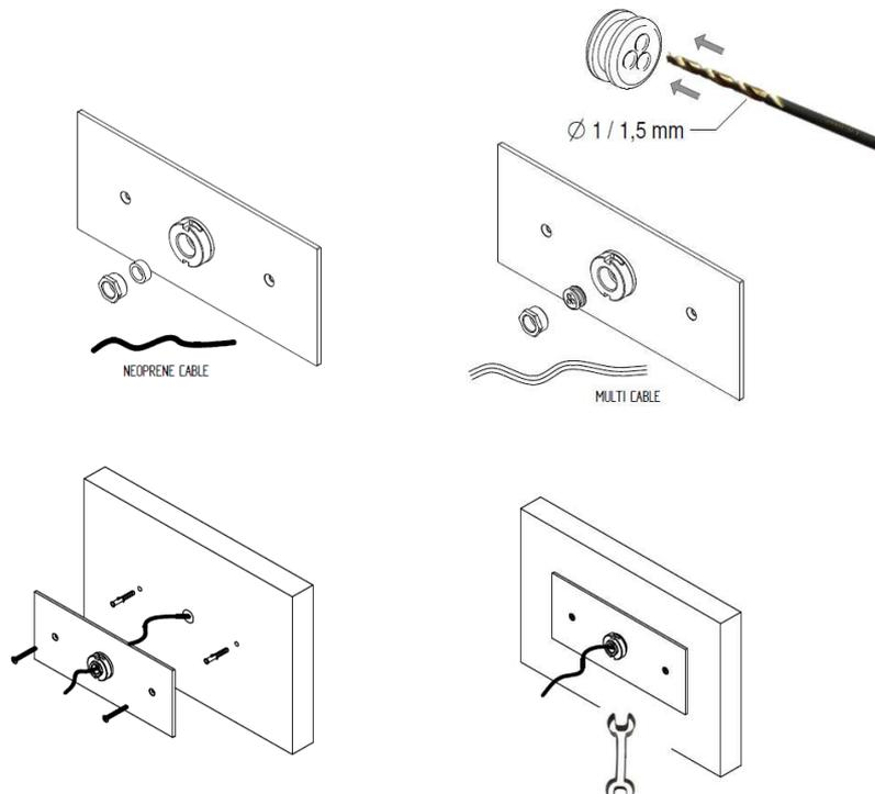
Eseguire il collegamento del prodotto utilizzando il connettore in dotazione, collegare fase, neutro e cavo di terra. Più prodotti tra loro devono essere collegati in parallelo.
