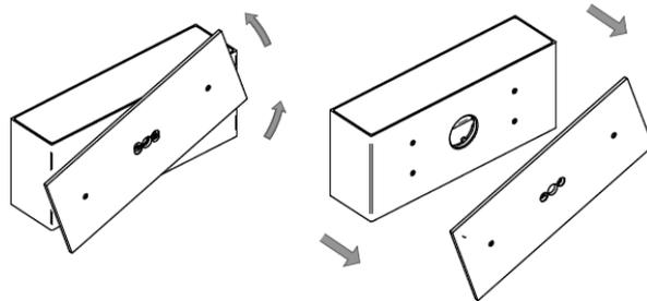
Eeguire I 2 fori di fissaggio con interasse 120mm
