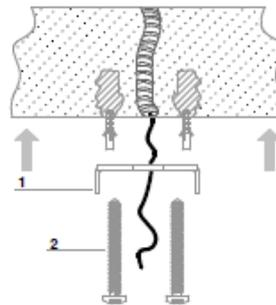
I prodotti Stige 6.7W e Stige IP54 4.8W vanno alimentati a tensione di rete 220/240Vac. Prima di eseguire i collegamenti assicurarsi di operare in assenza di tensione.
