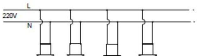
Per i collegamenti utilizzare un cavo con sezione minima 1mm<sup>2</sup>.
