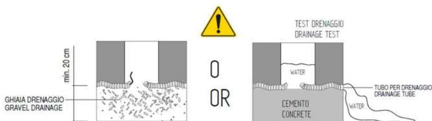
Posizionare e fissare la cassa facendo attenzione che il bordo sia allineato con il livello del pavimento finito. Cementare e rifinire prestando attenzione a non deformare la cassa.
