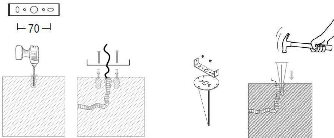
Eseguire il collegamento del prodotto utilizzando il connettore IP68 in dotazione ed avvitare il prodotto alla staffa tramite le 2 viti laterali. I prodotti Kop vanno alimentati a tensione di rete 220/230 Vac. Collegamento in parallelo.
