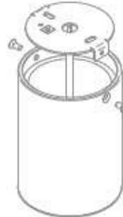
Fissare la staffa al soffitto tramite viti e tasselli in dotazione
