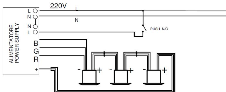
Con il cavo in dotazione è possibile sincronizzare max 20 apparecchi, Master con ponticello inserito (C) e slave senza ponticello (B).
