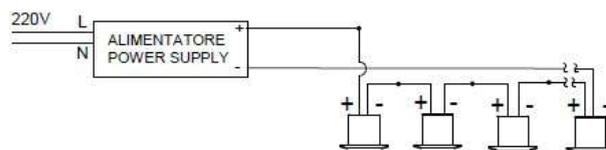
**La tensione di rete può essere ripristinata solo a carico applicato, il collegamento del carico in presenza di tensione può causarne la rottura.**
