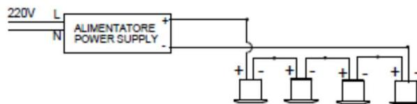
La giunzione al cavo in dotazione deve essere correttamente isolata, si raccomanda l'utilizzo di connettori IP67 o muffole con gel, una connessione non idonea può comportare infiltrazioni dovute alla risalita d'acqua dal cavo.
